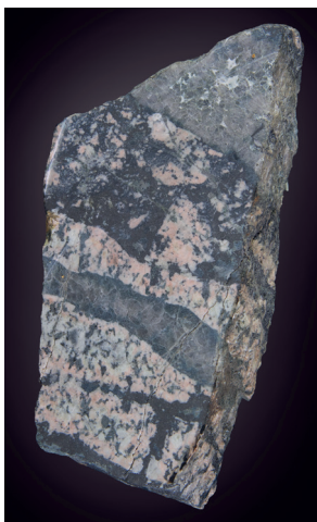
Рис. 6. Пржилки золото-кварц-актинолит-магнетитовой руды в калишпатизированном протерозойском граните. Карийское месторождение (участок Новинка), Восточное Забайкалье. Коллекция А.С. Ваха, В.И. Гвоздева, Д.Г. Федосеева, Н.А. Горячева. Фото Т.Б. Князевой
