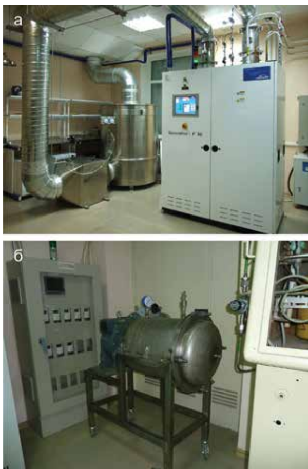
Рис. 5. Внешний вид генератора Generation-F80® (а) и реактора для фторирования (б) углеродных материалов
