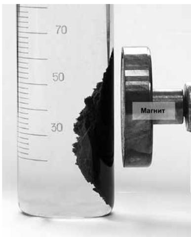
Рис. 4. Магнитные свойства ферритизированного осадка
