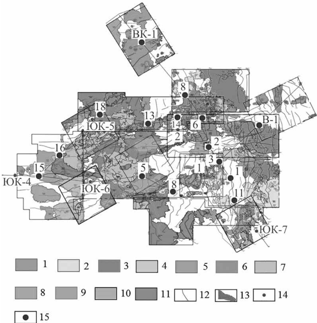
Рис. 5. Карта геологических опасностей на Южно-Кириинском нефтегазоконденсатном месторождении по данным сейсморазведки высокого разрешения. 1–11 – зоны газопроявлений отражающих горизонтов: 1 – wbt–Sg1, глубина 10–55 м от морского дна, 2 – Sg1–Sg2, глубина 30–100 м, 3 – Sg2–Sg3, глубина 150–180 м, 4 – Sg3–Sg4, глубина 180–210 м, 5 – Sg4–Sg5, глубина 160–280 м, 6 – Sg5–Sg6, глубина 210–330 м, 7 – Sg6–Sg7, глубина 260–410 м, 8 – Sg7–Sg8, глубина 340–440 м, 9 – Sg8–Sg9, глубина 380–500 м, 10 – Sg9–Sg10, глубина 440–650 м, 11 – Sg10–Sg11, глубина 570–720 м; 12 – разрывные нарушения; 13 – контур фронтальной части турбидитового потока; 14 – пробуренные скважины и их номера; 15 – проектные скважины и их номера
