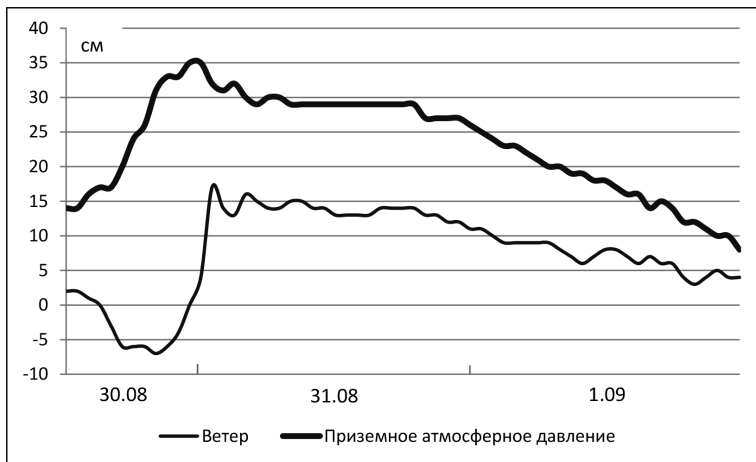
Рис. 2. Рассчитанные с помощью численного моделирования компоненты стонно-нагонной составляющей суммарного уровня моря во Владивостоке (12 ч ВСВ 30 августа – 23 ч 1 сентября 2016 г.), сформированные действием ветра и приземного атмосферного давления
