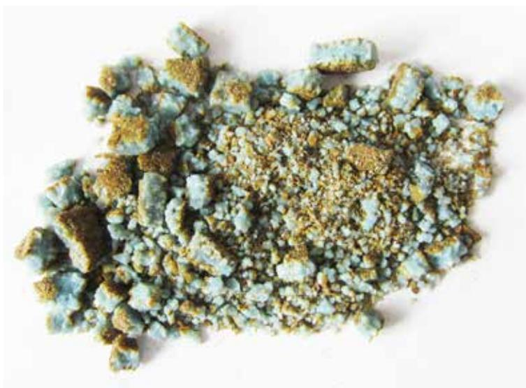
Рис. 1. Отложения из скважины Среднехарьягинского месторождения
