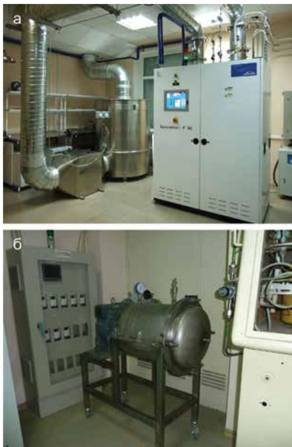
Рис. 5. Внешний вид генератора Generation-F80® (а) и реактора для фторирования (б) углеродных материалов
