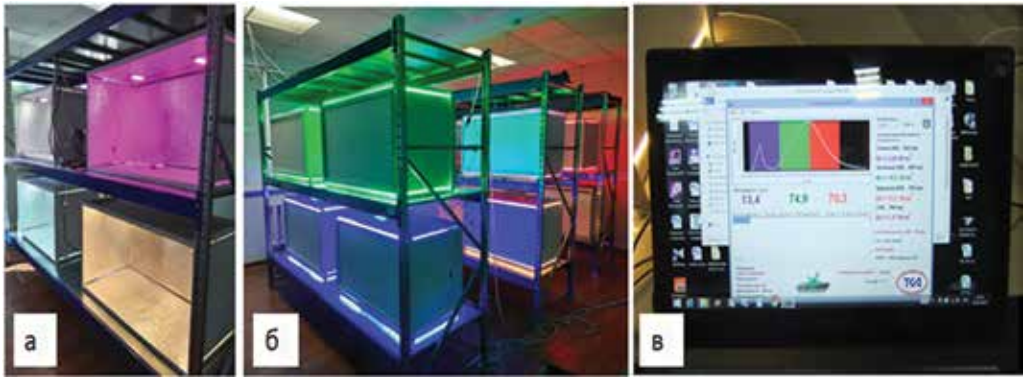
Фото 23. Световые климатические боксы (а, б), подготовленные для экспериментов по выращиванию растений с заданными сценариями освещения, и монитор автоматизированной системы управления освещением (в)
