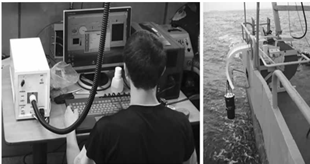
Фото 12. Судовой мобильный лазерный комплекс с волоконно-оптическим погружаемым модулем для экологического мониторинга
