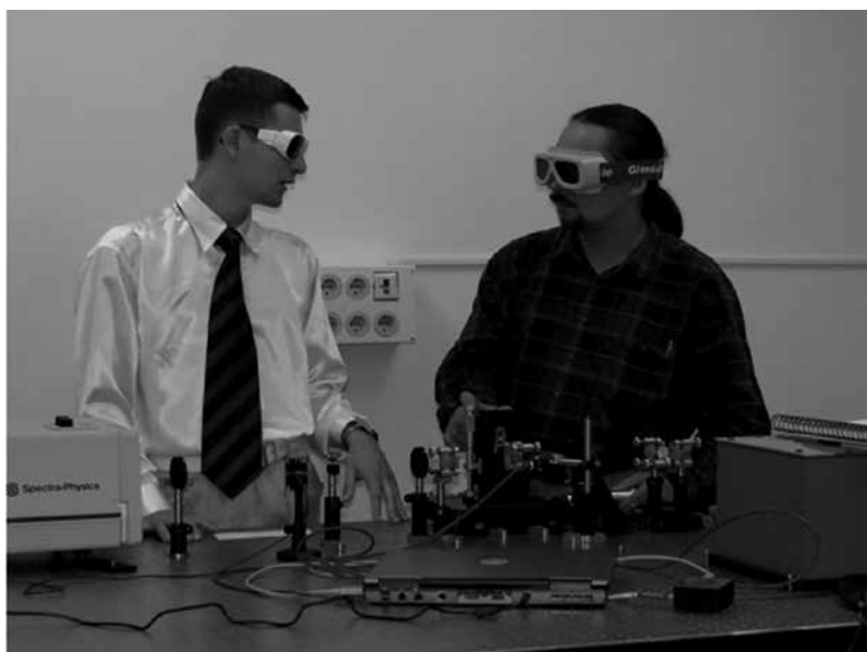
Фото 10. Фрагмент фемтосекундной лазерной установки для изучения процессов взаимодействия ультракоротких импульсов лазерного излучения с различными средами
