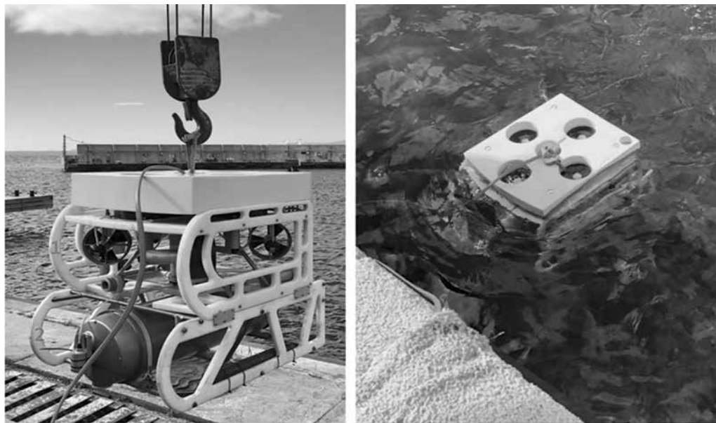
Фото 11. Телеуправляемый подводный аппарат, оснащенный ЛИС-спектрометром для анализа химического состава морской воды и донных отложений
