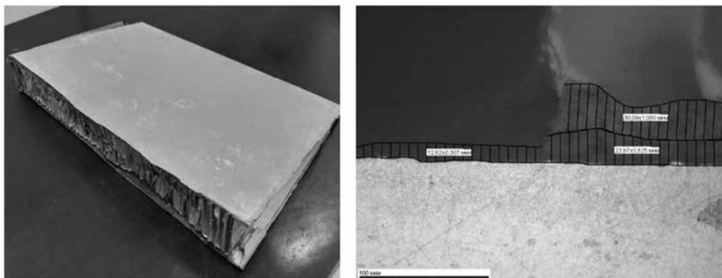
Рис. 1. Образец, изготовленный из элемента крыла ВС КБ Сухого: *а* – фрагмент элемента крыла самолета КБ Сухого, *б* – поперечный разрез элемента лакокрасочного покрытия
