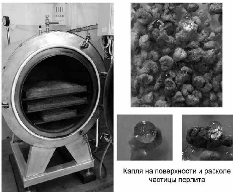
Рис. 4. Получение гидрофобного сорбента на основе вспученного перлитового гравия
