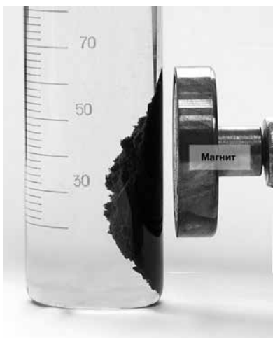
Рис. 4. Магнитные свойства ферритизированного осадка
