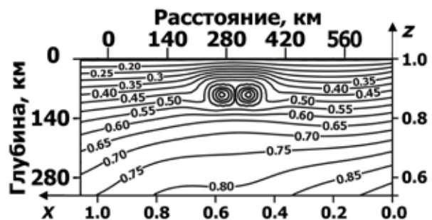
Рис. 6. Глубинный разрез с распределением безразмерной температуры (изотермы изображены с интервалом 0,05) и функцией тока (вихревые линии тока, показаны с интервалом 4) на стадии максимального проникновения теплового диапира в литосферную плиту Охотского моря. Диапир почти изотермичен (с температурой \sim 1000 К). Максимальный конвективный тепловой поток \sim 10^3 мВт \cdot м 2 над центром конвективной ячейки перераспределяется по ширине конвективной ячейки и обеспечивает поверхностный тепловой поток \sim 130 мВт \cdot м 2 со дна Охотского моря на расстоянии \sim 280 км к востоку от о-ва Сахалин
