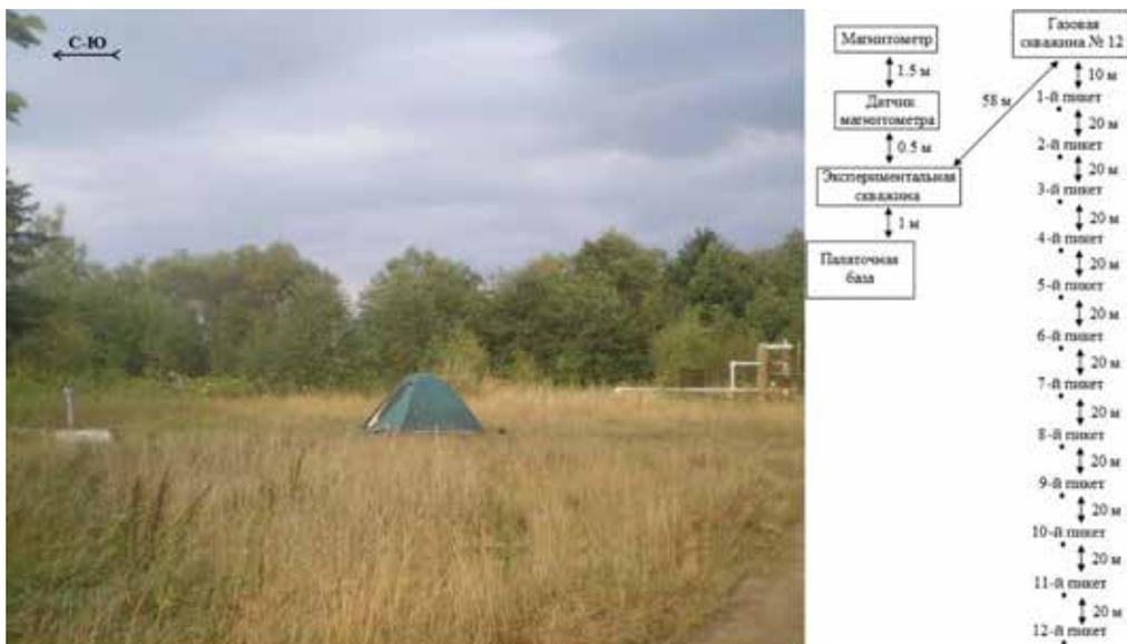
Рис. 2. Фотография газовой скважины № 12 с обзорной схемой расположения аппаратуры и профиля
