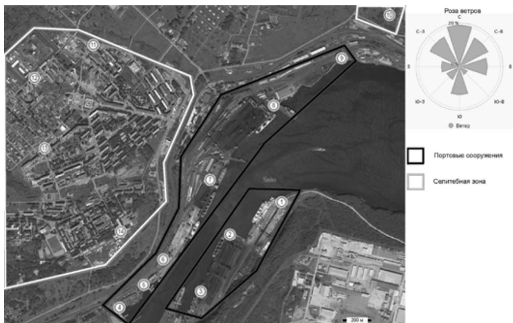
Рис. 2. Точки инструментального измерения количественного состава (счетной концентрации) взвешенных в воздухе частиц с помощью ручного лазерного счетчика в пос. Ванино
